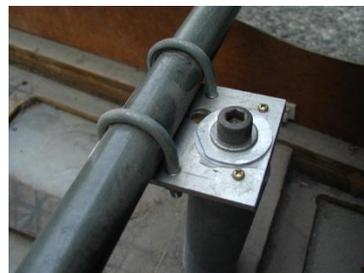
前輪の車軸取り付け部
