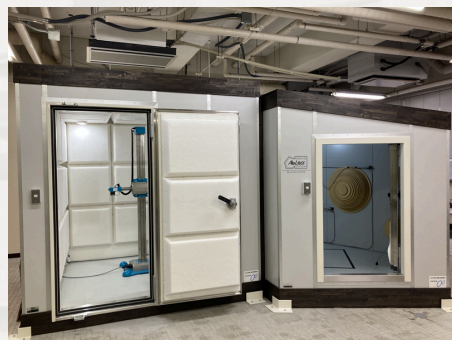
吸音率・音響透過 損失測定装置
