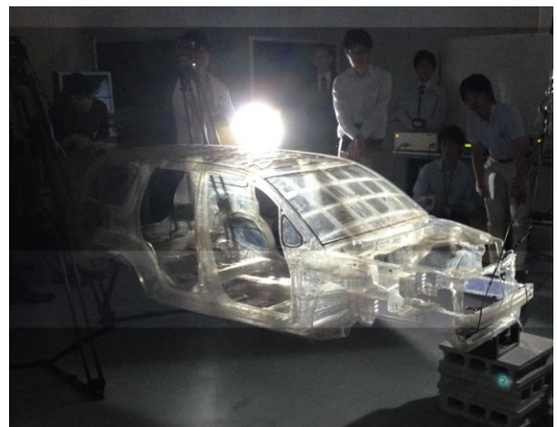
「デモ4」 振動の可視化(ストロボ)：三菱自動車工業(株)
