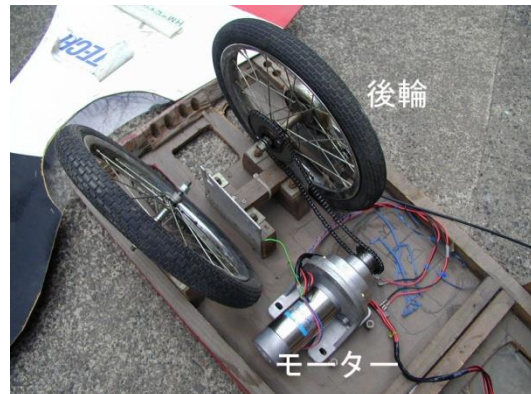
取り付け前に、とりあえずモーターや後輪を並べてみたところ
