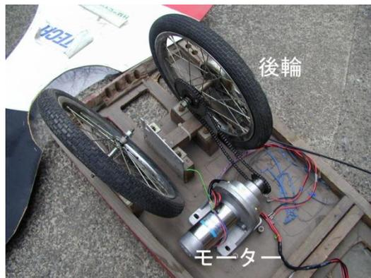
前輪の車軸取り付け部
